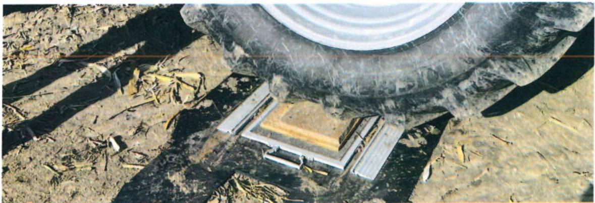
**Abbildung 16: Achsverwiegung mittels Plattenwaage im Feld**
