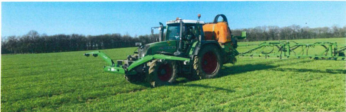
**Abbildung 11: Teilflächenspezifische mineralische Düngung mit Crop-Sensor**
